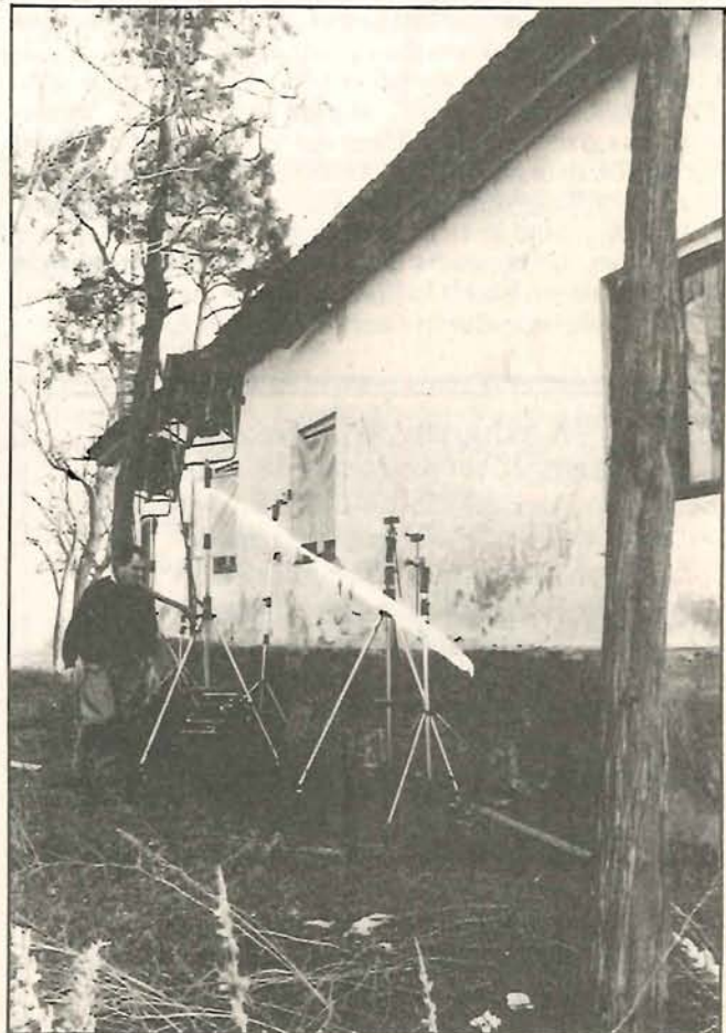
A forgatókönyv szerint a kocsmablakon át besüt a Nap, melynek fényét a kinti reflektorok szolgáltatják
