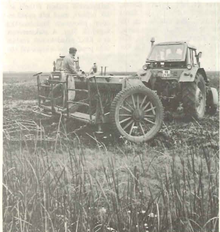
MTZ-80-as erőgéppel vontatott Lajta vetőgéppel vetik a káposztarepce-magot
